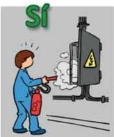
En caso de avería o mal funcionamiento de un equipo de trabajo, desconéctalo, señaliza la avería y avisa a tu encargado.
